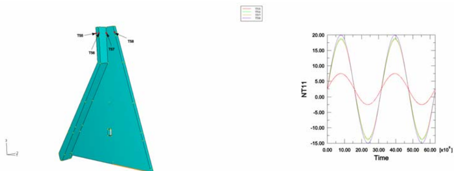
Figur 8.26 Temperatur för referensnoderna T55-T58 belägna mitt i monoliten
