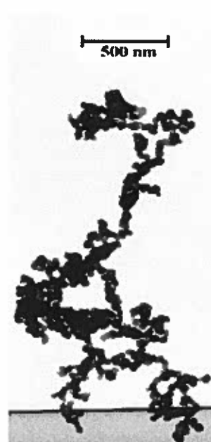
Bild 1. Partikel från fotogenlampa. Partikeln har bildats genom att små sfäriska partiklar slagit ihop sig till ett aggregat. Foto: Arash Gharibi
