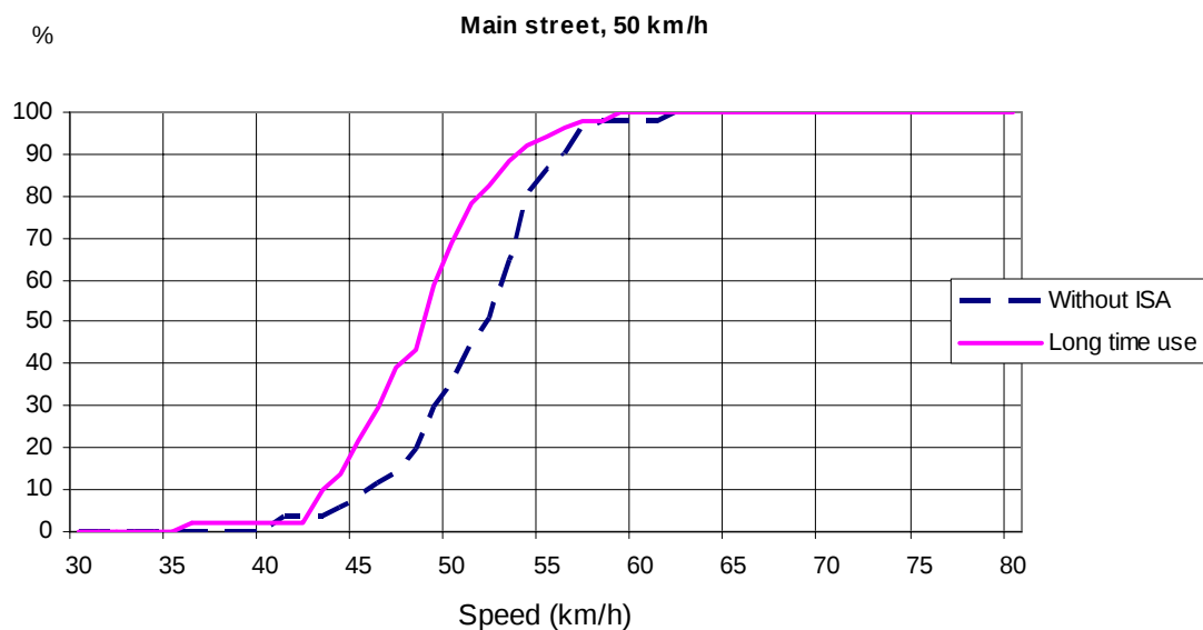
Figur 10. Fördelningskurva för hastigheter på huvudgata, 50 km/h.
