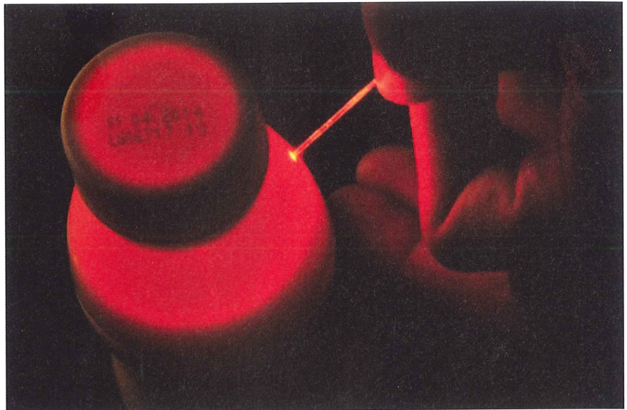
4. Rött ljus skickas med hjälp av en optisk fiber in i en dryckesförpackning av vit plast. Ljuset blir snabbt diffust vilket gör att sträckan ljuset går inuti förpackningen blir mycket svår att veta. Då krävs speciella knep för att kunna använda sig av absorptionspektroskopi för kvantitativa gasanalyser.
