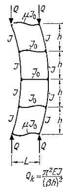
Fig 55y. Flerväningsram. [78], [91], [119]–[122]. För beräkning av det allmänna fallet med olika styrheter och axial-krafter i de olika väningarna hänvisas till bl a [121] och [123]. Närmeformler för detta fall anges i [124] för upp till 4-väningsram
