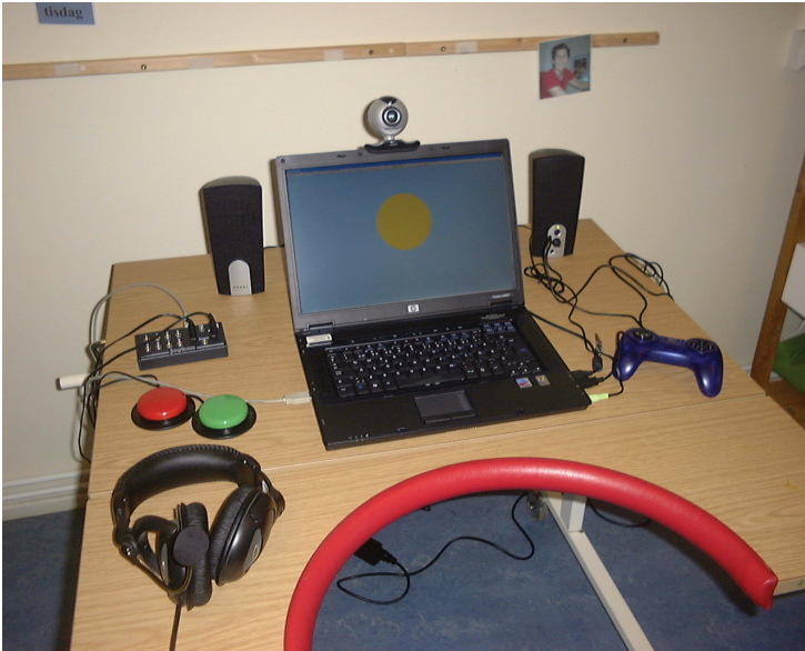
Figur 38. Dagens mobila Minimeter är baserad på en bärbar dator. Minimetern styrs antingen genom rörelser, t.ex. huvudvridningar som fångas upp av videokameran (på bildskärmens överkant) eller med hjälp av tryckknappsfunktioner, t.ex. de båda stora röda och gröna tryckknapparna på bilden. Med joypaden (den blå till höger om datorn) kan forskningspersonens medhjälpare styra många av Minimeterns funktioner, och även interagera med forskningspersonen.
