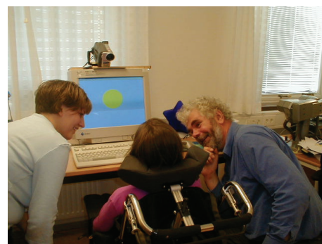
Figur 9. Emma provar Minimeterns rullande klot. Genom huvudvridningar rullar hon klotet på bildskärmen till höger eller vänster. När klotet kommit till endera kanten hörs ett distinkt Ja eller Nej i datorns högtalare, och hela skärmen blir grön eller röd. På detta vis kan Emma svara Ja eller Nej .
