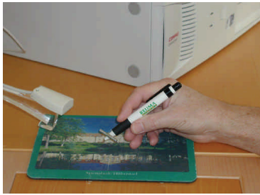
Figur 27. Den tvådimensionella luftmusen. Här används en penna med en fastsatt permanentmagnet till att styra. Den vita dosan till vänster innehåller de båda magnetgivarna.
