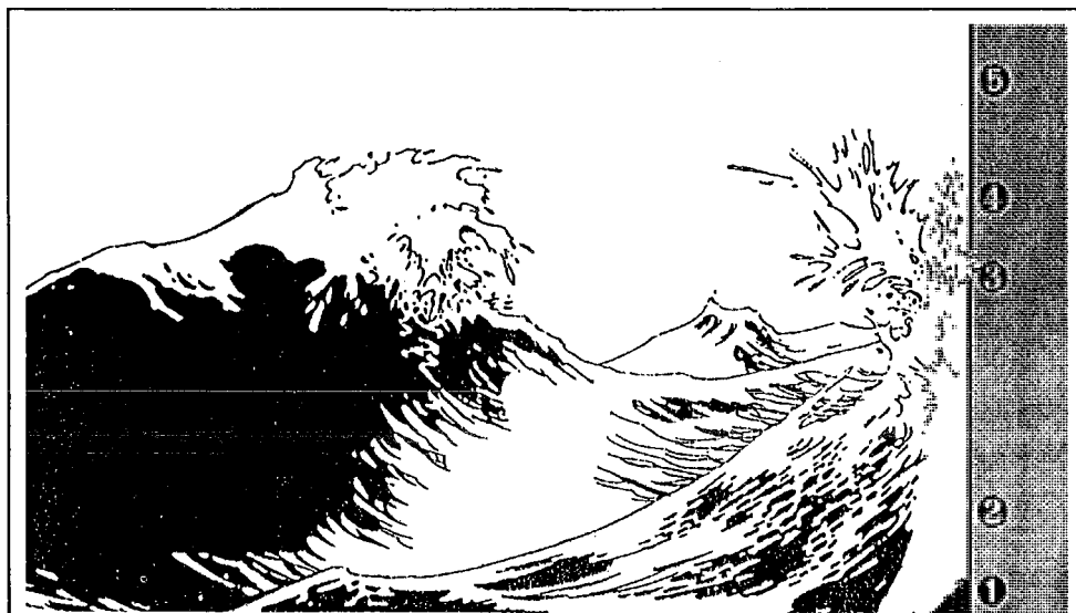
Figur 3. Betonkonstruktioner i marint miljø udsættes for både vand- og luftbårne chlorider fra havvand. Alle transportformer for chlorid kan forekomme: Diffusion (1), permeation (2), kapillarsugning (3), opvædning med udtørring (4) samt kapillarsugning med fordampning (5). Bølger frit efter Daniel Herotin.
