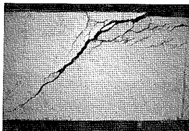
Fig. 7 e Balk nr 3 efter brott.
