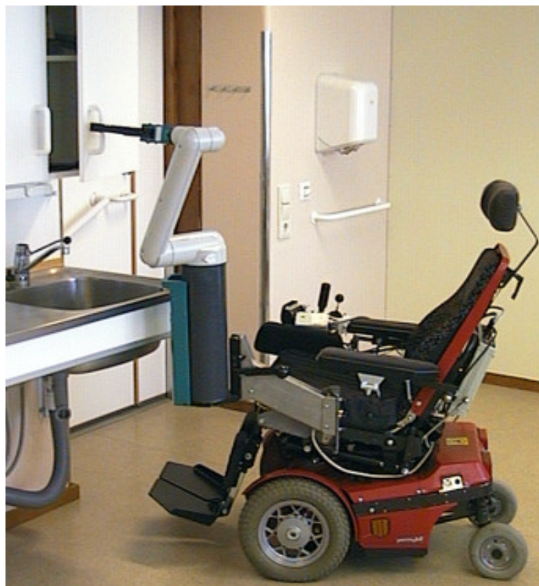
Bild 10. Manus-armen monterad på en rullstol.
