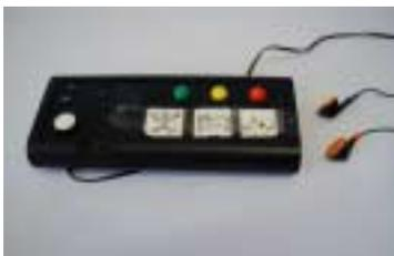
Problemen med febertermometerar rör både skalans kontinuerliga utformning och tolkningen av resultatet. Melker Danielson och Peter Appelgren utvecklade en prototyp av en termometer där skalan ersatts av tre bilder och tre lampor. Grön lampa och bilden av en glad skuttande människa skulle tolkas som frisk, gul lampa i kombination med en sängliggande man betydde feber/sjuk och röd lampa och en bild av en ambulans betydde hög feber/kontakta läkare.
