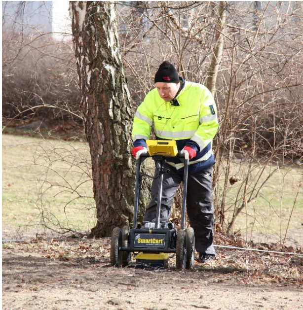
Figur 1. Lars Winroth med georadarutrustningen på Rosenlund i Jönköping hösten 2011. Foto: Laila Wing, Modern Arkeologi KB
