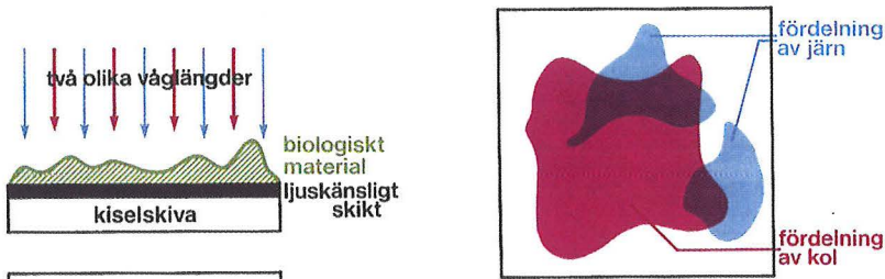
Fig 25 Selektiv fotografering. Med hjälp av synkrotronstrålning kan man ta reda på hur två ämnen, ex järn och kol, fördelar sig i ett material som består av olika ämnen.
