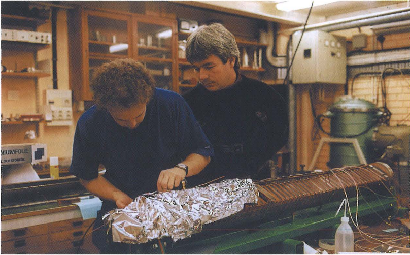
Fig 60 Greg LeBlanc och Magnus Bobberg monterar en av de supraledande spolarna till wigglermagneten (2000). Foto Mikael Johansson.
