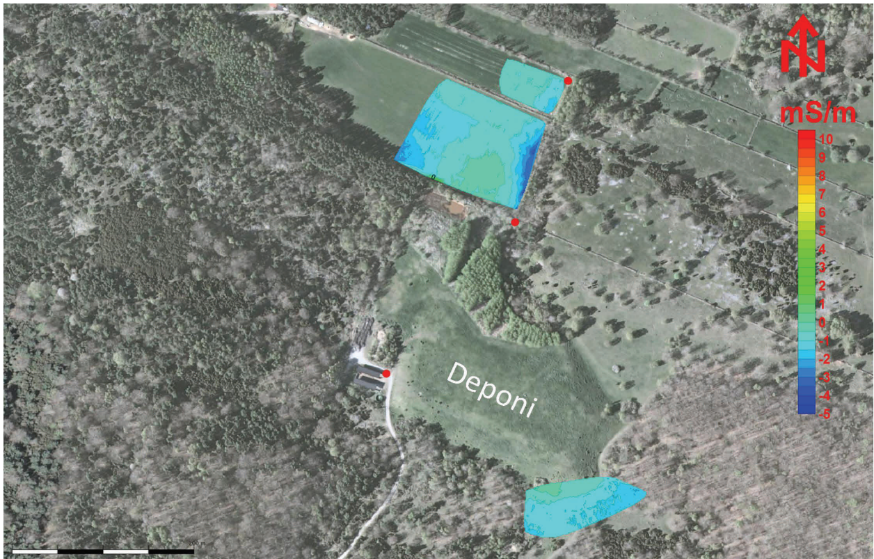
Fig. 20. Resultaten från stångslingramsundersökningen med frekvensen 35775 Hz. Röda fält har högre skenbar elektrisk ledningsförmåga än blå. Modifierad efter Lantmäteriet (2014).
