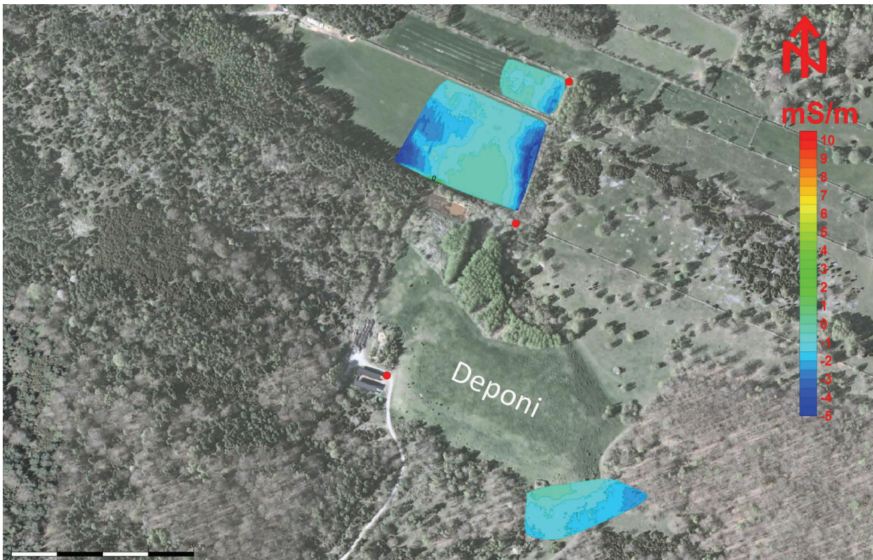
Fig. 21. Resultaten från stångslingramsundersökningen med frekvensen 60775 Hz. Röda fält har högre skenbar elektrisk ledningsförmåga än blå. Modifierad efter Lantmäteriet (2014).
