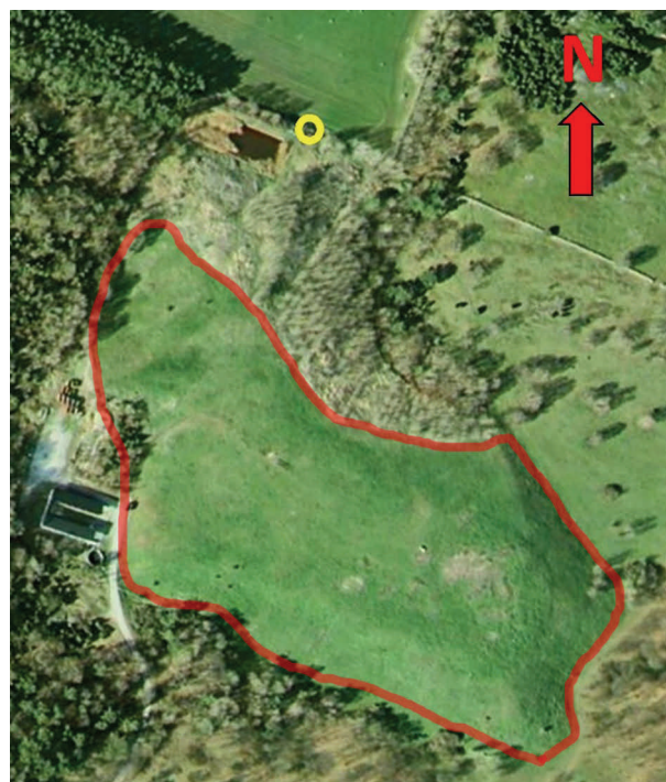
Fig. 10. Brunn där screeningprovet togs vilken symboliseras av den gula ringen. Provets plats är viktig eftersom vattnet i dräneringsbrunnen borde vara det första som blir påverkat från förorenat grundvatten från lakvattendammen. Modifierad efter Lantmäteriet (2014)
