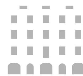
Samtliga öppningar linjerar både horisontellt och vertikalt. Tre av öppningarna på bottenplan är bredare än fönstren ovan, men är centrerade. Symmetrisk fönstersättning.
