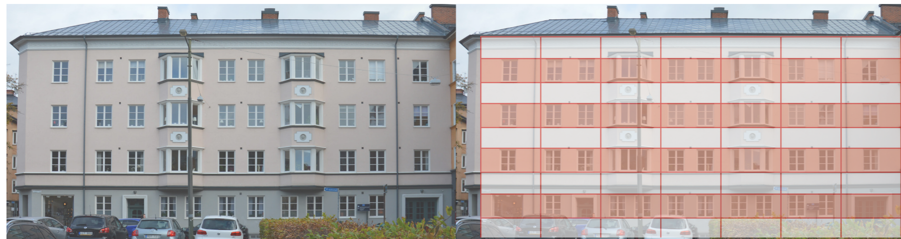
Rutnät med en tydlig vertikal indelning i sjundedelar.
