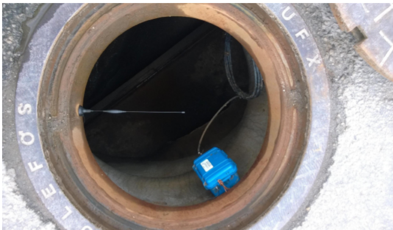
Figur 10. Exempel på integrerad sensorenhet med antenn, kapsling och fästanordning.
