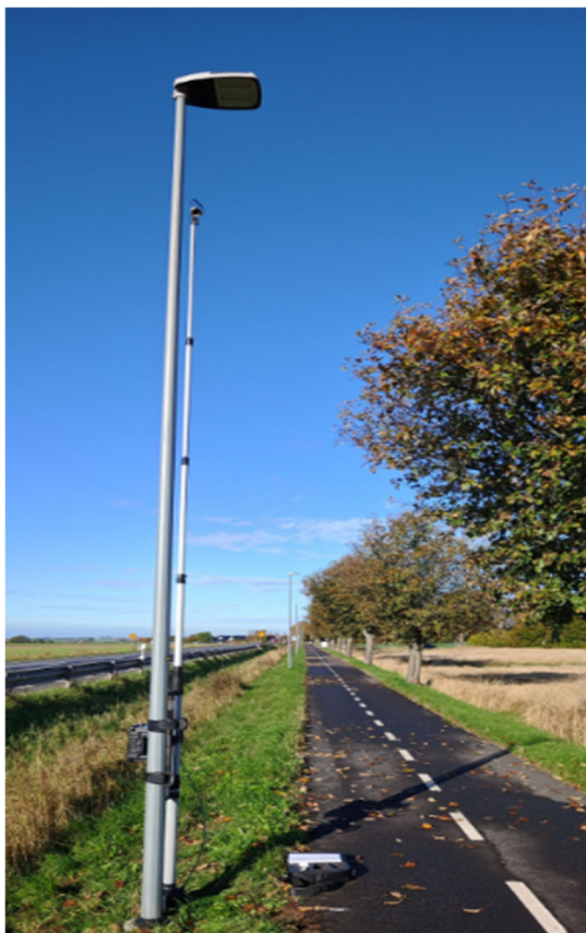
Figur 13 En färdigmonterad Miovision Scout på Dalbyvägen
