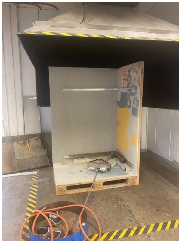
Figur 4 Visar hörnuppställningen med gasbrännaren.
