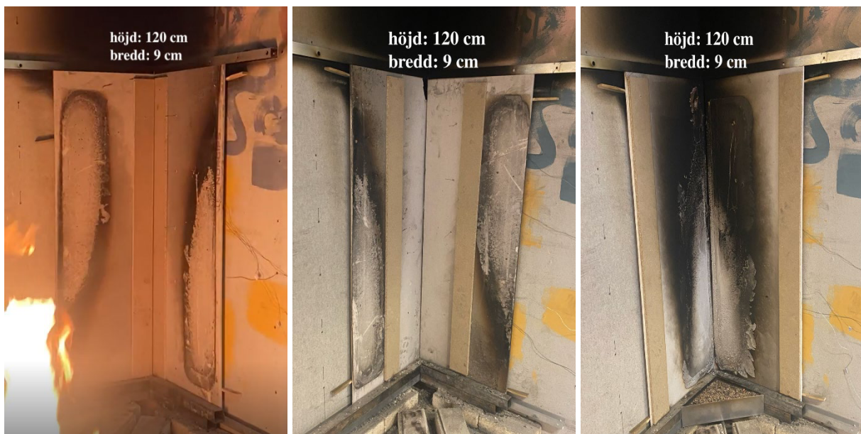
Figur 11 Visar uppställningarna för grupp 2 med testbitarnas dimensioner. Från vänster: 2A, 2B och 2C.
