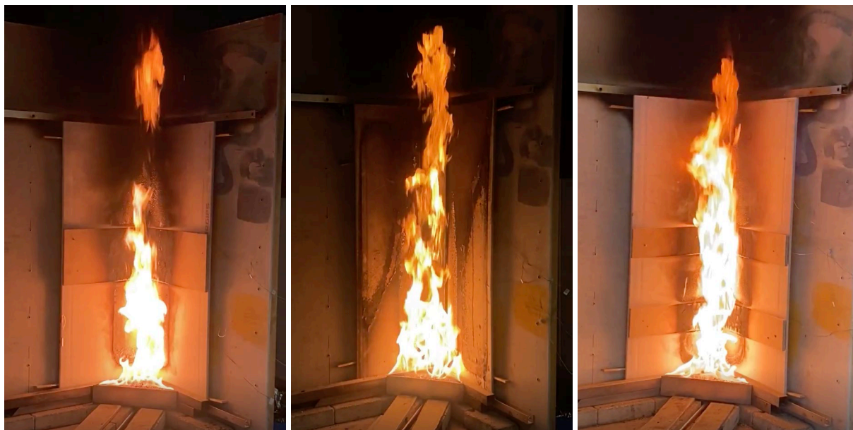
Figur 31 Visar en stillbild av flammhöjden vid 300 sekunder. Från vänster: 1B, 2A och 3Arep.
