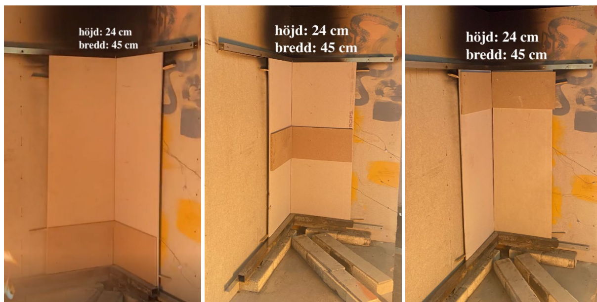
Figur 7 Visar uppställningarna för grupp 1 med testbitarnas dimensioner. Från vänster: 1A, 1B och 1C.
