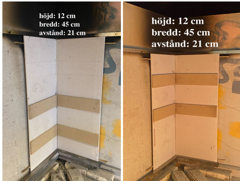
Figur 15 Visar uppställningarna för grupp 3 med dimensioner för varje testbit och avståndet mellan dem. Från vänster: 3A och 3B
