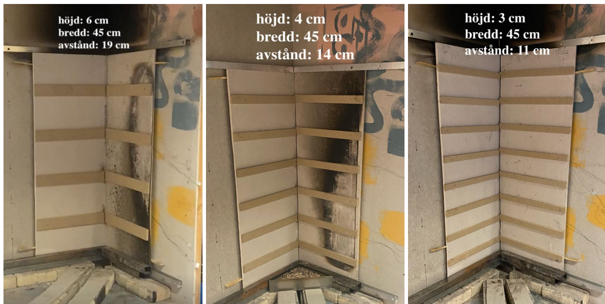
Figur 23 Visar uppställningarna för grupp 5 med dimensioner för varje testbit och avståndet mellan dem. Från vänster: 5A, 5B och 5C.
