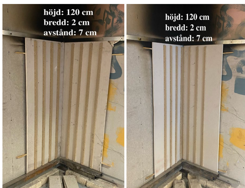
Figur 27 Visar uppställningarna för grupp 6 med dimensioner för varje testbit och avståndet mellan dem. Från vänster: 6A och 6B.
