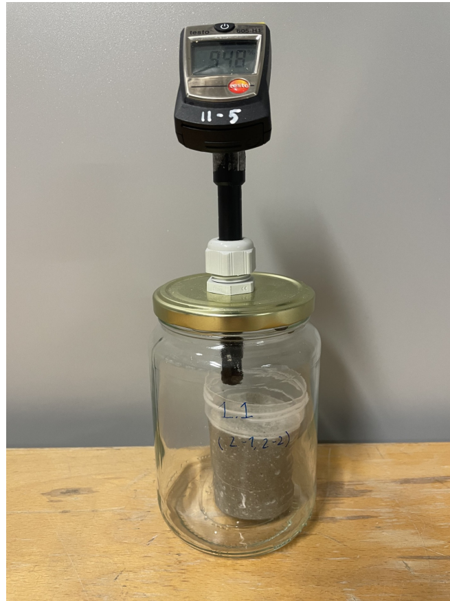
Figur 5.13: Förseglad burk med cementbruksprov och monterad T-prob.
