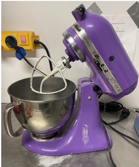
(a) KitchenAid Artisan som används för att tillreda cementbruksprover.
