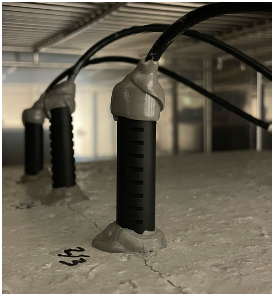
Figur 5.7: Plaströr monterat i provkroppen med V-prob installerad i röret och tätningssmassa i anslutningar.
