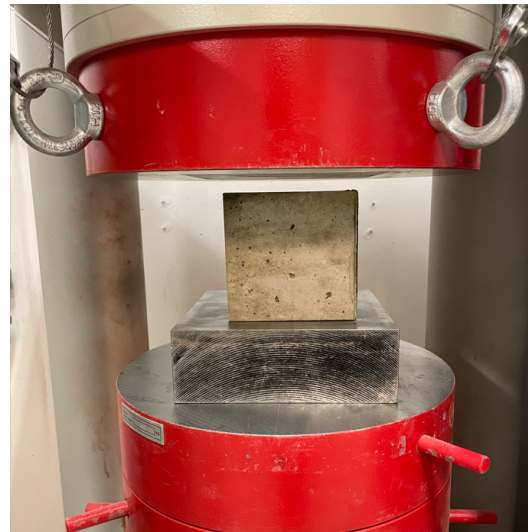
(b) Betongkub som placerats i tryckpressen.
