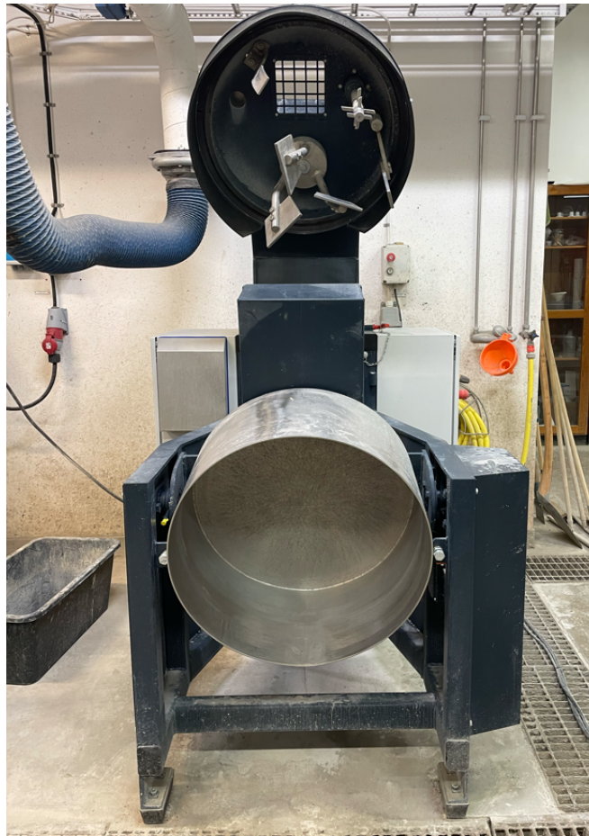
Figur 5.4: Betongblandare av varumärket Zyklus ZK 50 HE som använts i arbetet.
