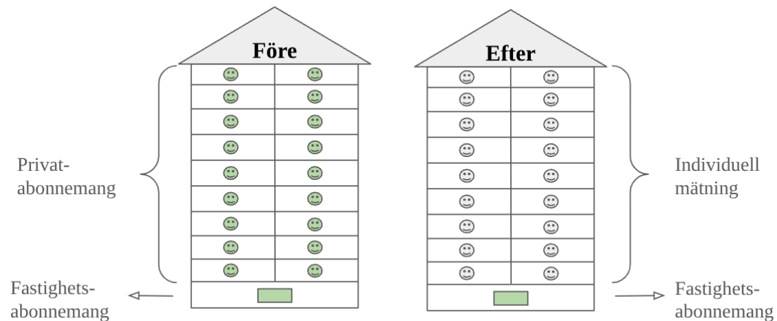
Figur 8: Illustration av IMD. Före IMD har varje boende ett eget elabonnemang, efteråt är det endast fastigheten som har ett abonnemang (egen illustration).
