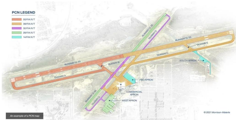
Figur 2: En PCN-karta som visar hur PCN-värdena kan variera på en flygplats (Kesler, u.å.).
