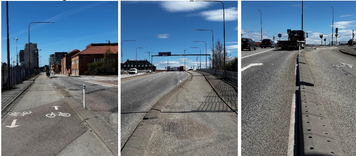
Figur 4.3. Fältbilder från Carlskgatan. Bilderna visar GCM-stöd på en högtrafikerad huvudgata där stöden är placerade längs en relativt rak sträcka, samt anslutning mot korsning/cirkulation. Bilderna visar även kompletterande synlighetsåtgärder i form av pollare och linjemålning. Källa: privata foton.
