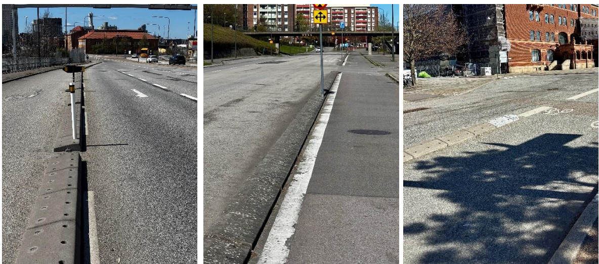
Figur 20. Från vänster till höger: Carlskgatan, von Rosens väg och Skeppsbron. På Skeppsbron är de avslutande GCM-stöden vitmålade, medan Carlskgatan och von Rosens väg har vägmarkeringar i anslutning till GCM-stöden. Källa: privata foton.
