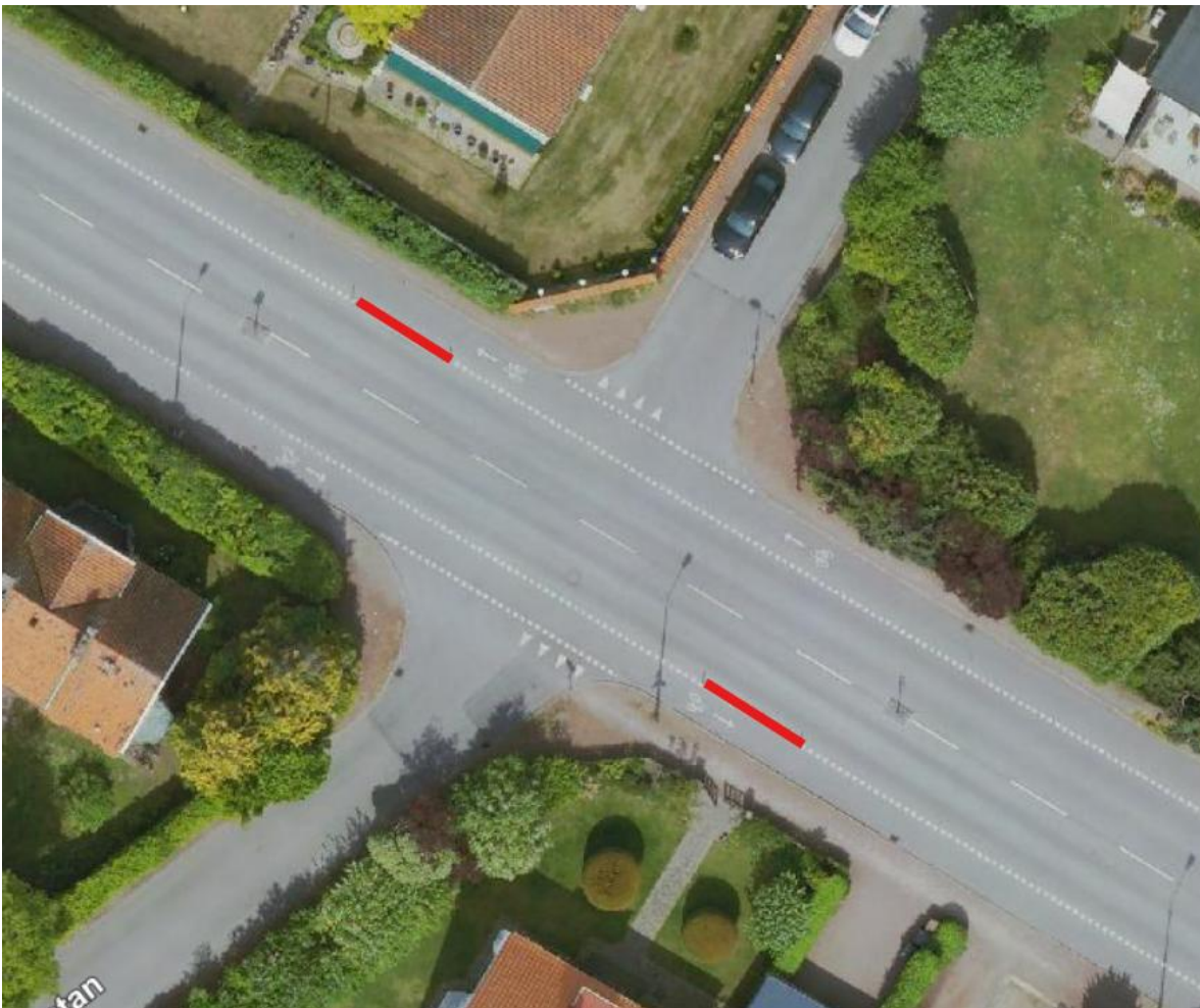
Figur 21. En av korsningarna på Geijersgatan och Sveciagatan med GCM-stöd markerat i rött för att styra svängande trafik. Källa: FGK-kartan.
