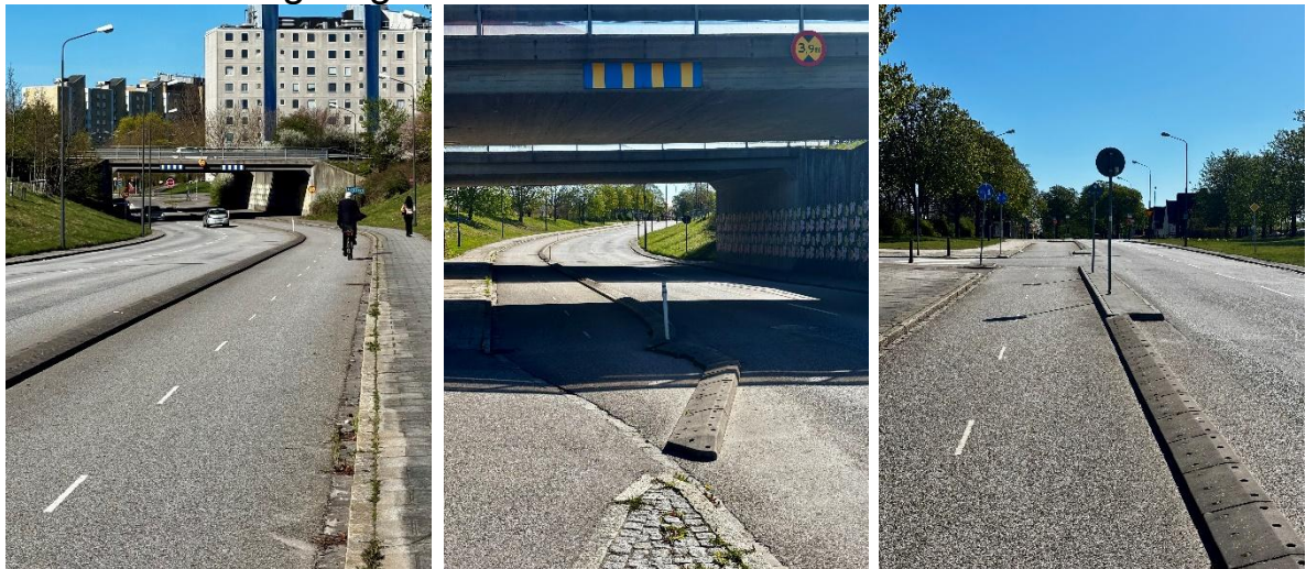
Figur 4.6. Fältbilder från Ellenborgsvägen. Bilderna visar GCM-stödets placering längs sträckan samt exempel på den omgivande gatu- och cykelmiljön. Den högre bilden visar även kombination av GCM-stöd och en bredare platsbyggd lösning vid in- och utfart. Källa: privata foton.
