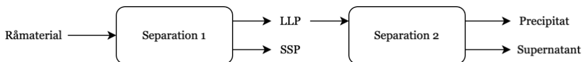
Figur 1. Flödesschema över extraktionsprocessen.
