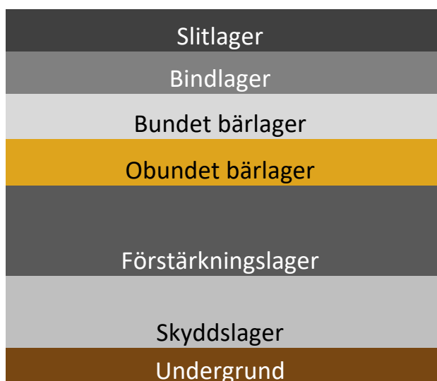
Figur 4. Principiell uppbyggnad av vägöverbyggnad.
