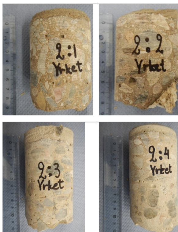
Figur 3.7: Bilden visar uttagna betongkärnor från håldäck. Källa: RISE, Rivningsobjekt från kostnad till resurs: Pilotstudie återbrukspotential för tunga stomdelar i två rivningsobjekt , 2021 [78]. Bild återgiven med tillåtelse.
