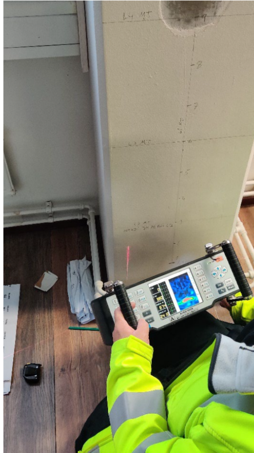
Figur 3.6: Bilden visar mätning av likformighet med icke-förstörande MIRA-anordning. Källa: Swedish country cluster, ReCreate project, Properties and quality of precast concrete elements deconstructed in ReCreate's pilots , 2024 [90], Photo © TAU/Aapo Räsänen. Bild återgiven med tillåtelse.
