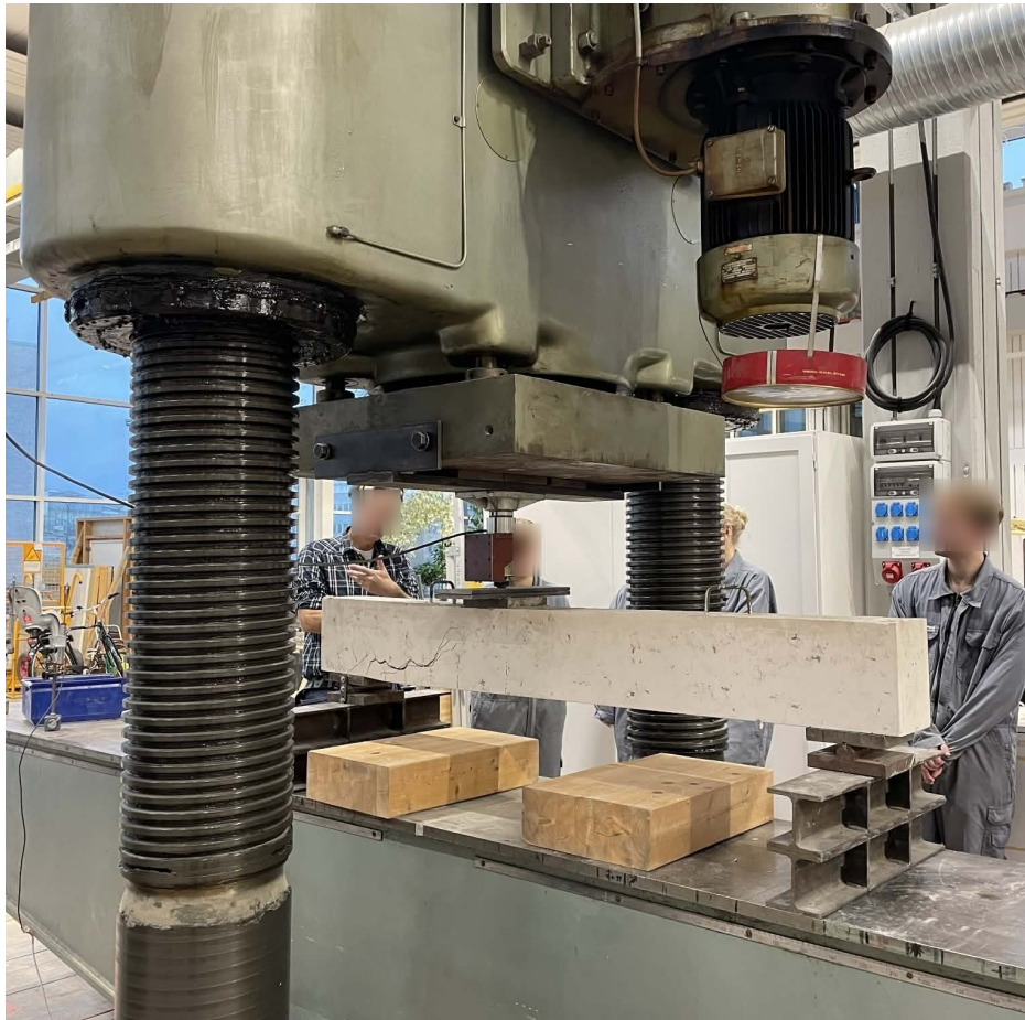
Figur 3.9: Bilden visar fullskalig provning på ett betongelement. Källa: egen bild.
