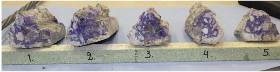
Figur 3.8: Bilden visar provkroppar från förstörande provning av karbonatiseringsdjup utförd med pH-indikator. Källa: RISE, Quality assurance for reused concrete building elements , 2023 [24]. Bild återgiven med tillåtelse.
