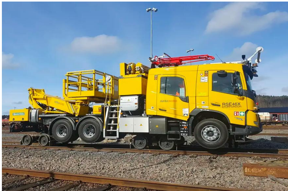
Figur 7 visar SRB för spårsvetsarbeten (Infranord, u.å. c)
