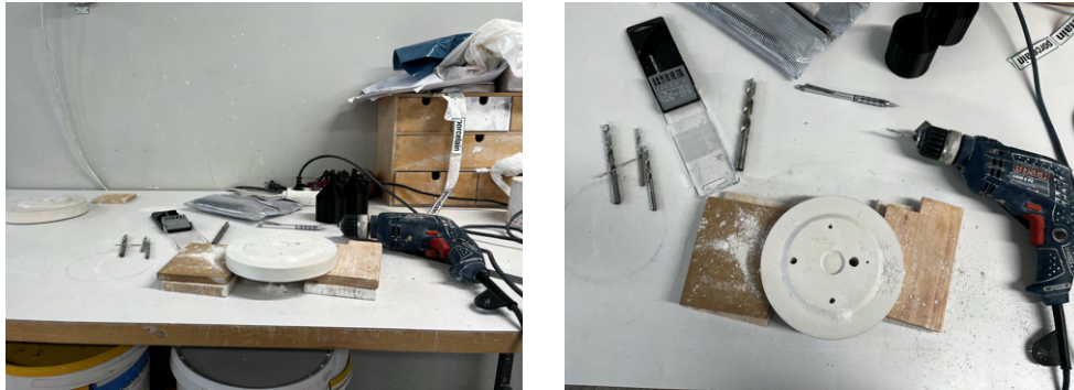
Figure 6.5: Drilling pour holes.
