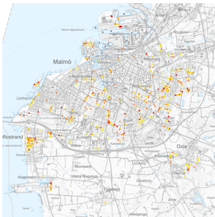
Figur 8: Karta över rotinträngningar på asfalterade gång- och cykelbanor med skadeklass 1–3, som motsvaras av gul, orange och röd (GIS-kartan).
