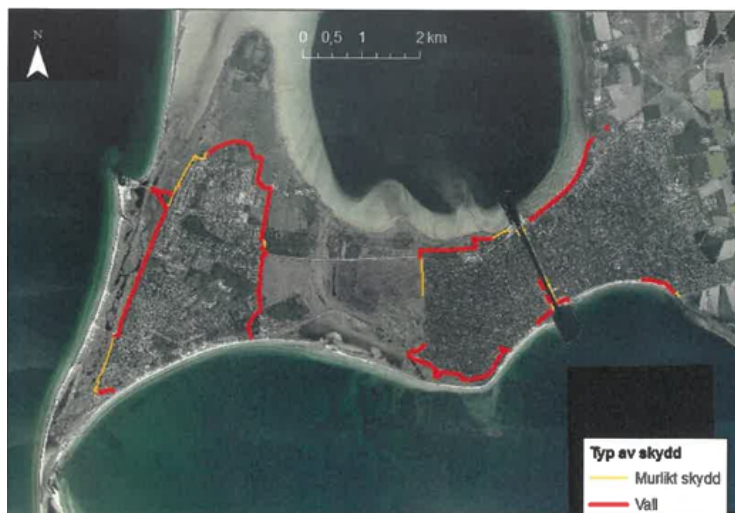
Figur 1. Sträckning av översvämningsskyddet, (Vellinge Kommun, 2024 a)
