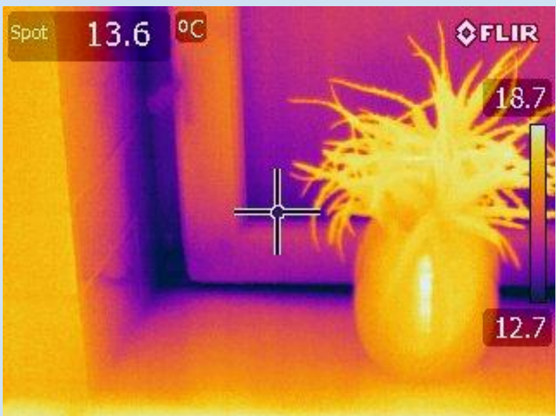
Termografering av en fönsteranslutning.
