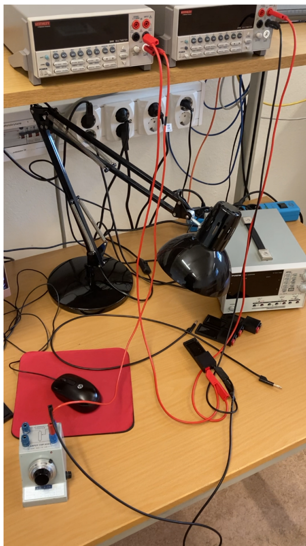
Figur 12: Kretsen som ska kopplas. Längst upp är två multimetrar. Längst ned till vänster syns potentiometern och till höger syns en svart solcell bredvid tre andra solceller. Följ sladdarna.
