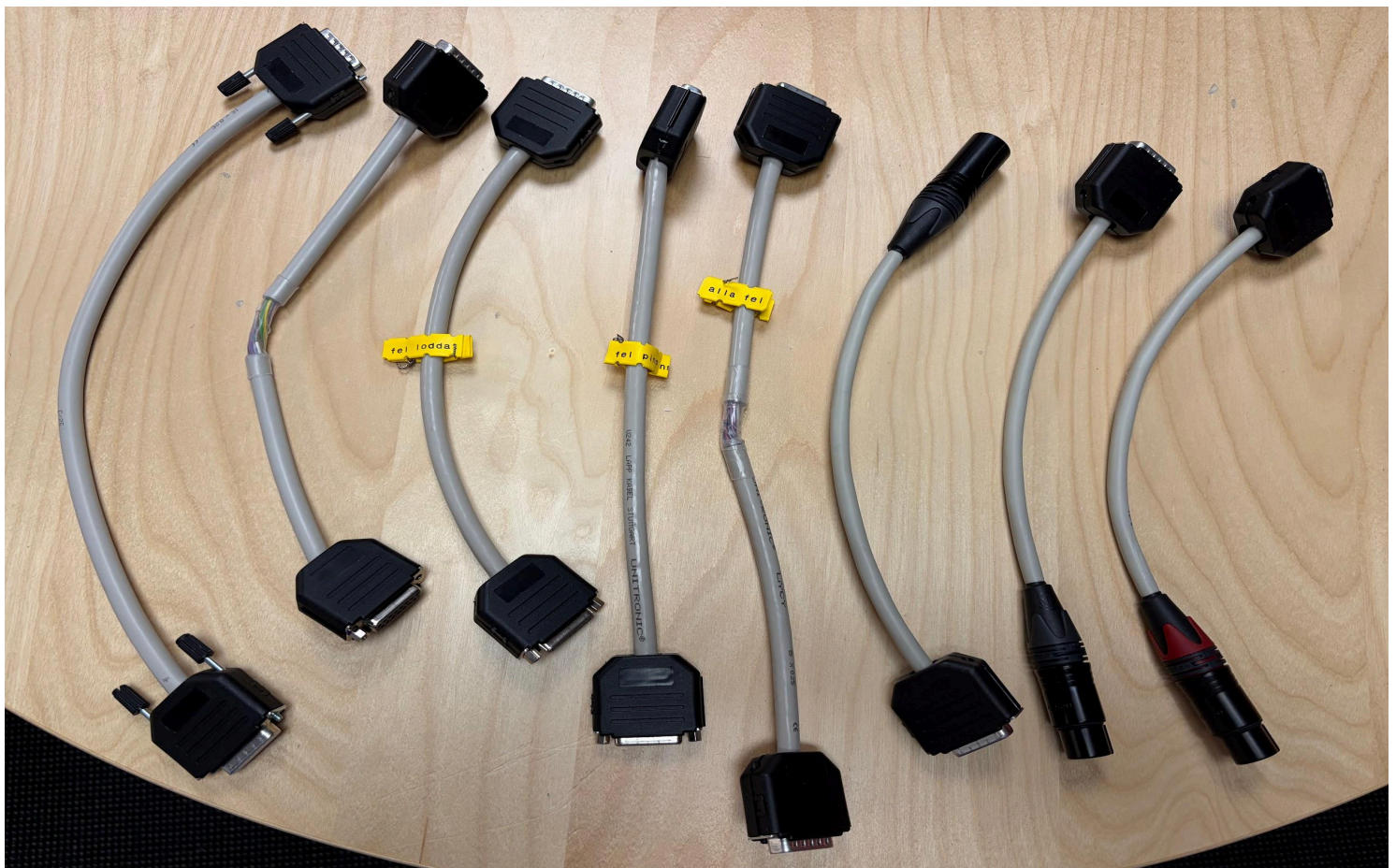
Figur 3.4: Kabel A - Fungerande kabel med alla 15 fungerande pins. Kabel B - Kabel med avbrott i ledare 1,8,9 och 15. Kabel C - Kabel med kortslutningsfel mellan pin 1-2, 7-8 och 14-15. Kabel D - Kabel med korskoppling mellan pin 4-5 och 9-10. Kabel E - Kabel med alla fel som, kortslutning
