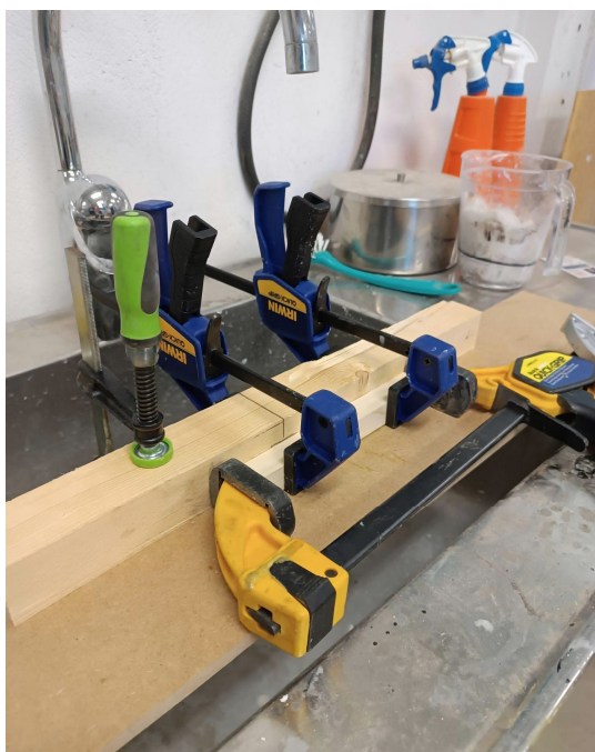
Figur 3.3 Figuren visar limningen av en liten granprovkropp med tvingar.
