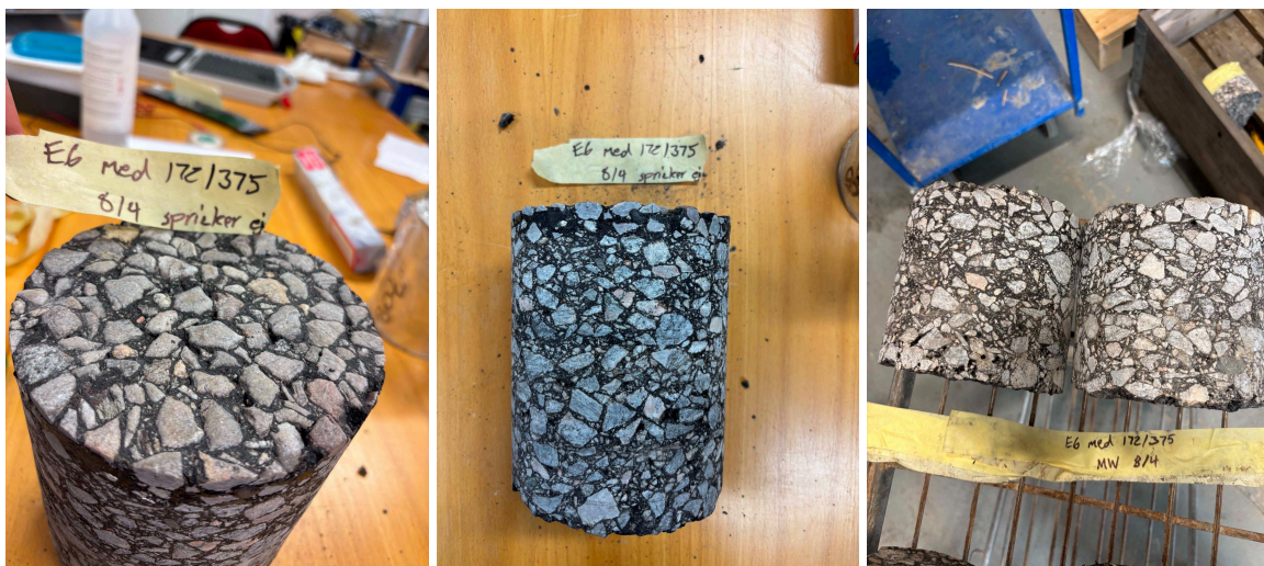
Figur 14: Borrkärnor från E6 referens. Den vänstra bilden visar hur slitlagret ser ut. Bilden i mitten visar lageruppbyggnaden för en borrkärna i hjulspår. Bilden till höger visar Ø150 mm borrkärnor mellan hjulspår.
