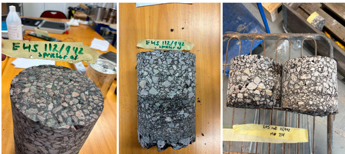
Figur 16: Borrkärnor från E45 referens. Den vänstra bilden visar hur slitlagret ser ut. Bilden i mitten visar lageruppbyggnaden för en borrkärna i hjulspår. Bilden till höger visar Ø150 mm borrkärnor mellan hjulspår.
