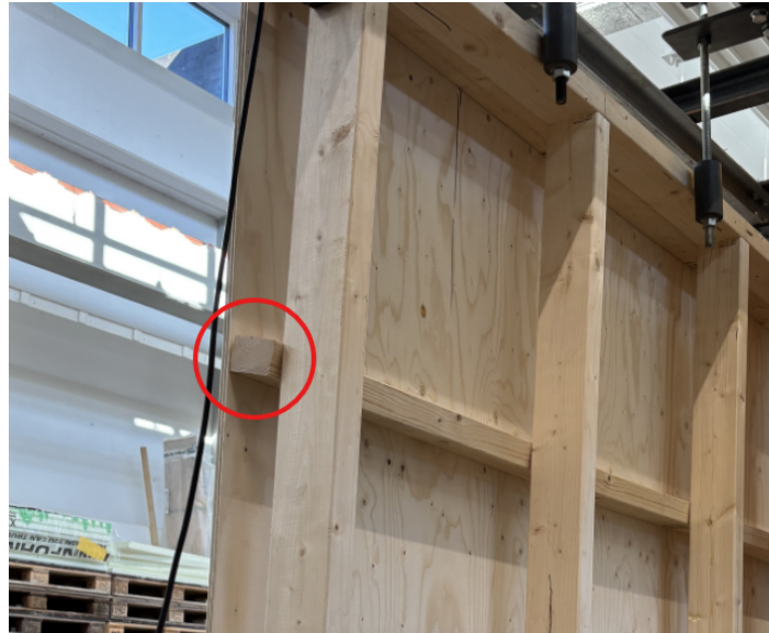
Figur 5.2: Skivans och installationsskiktets deformation relativt huvudstommen efter provning, vägg 3.
