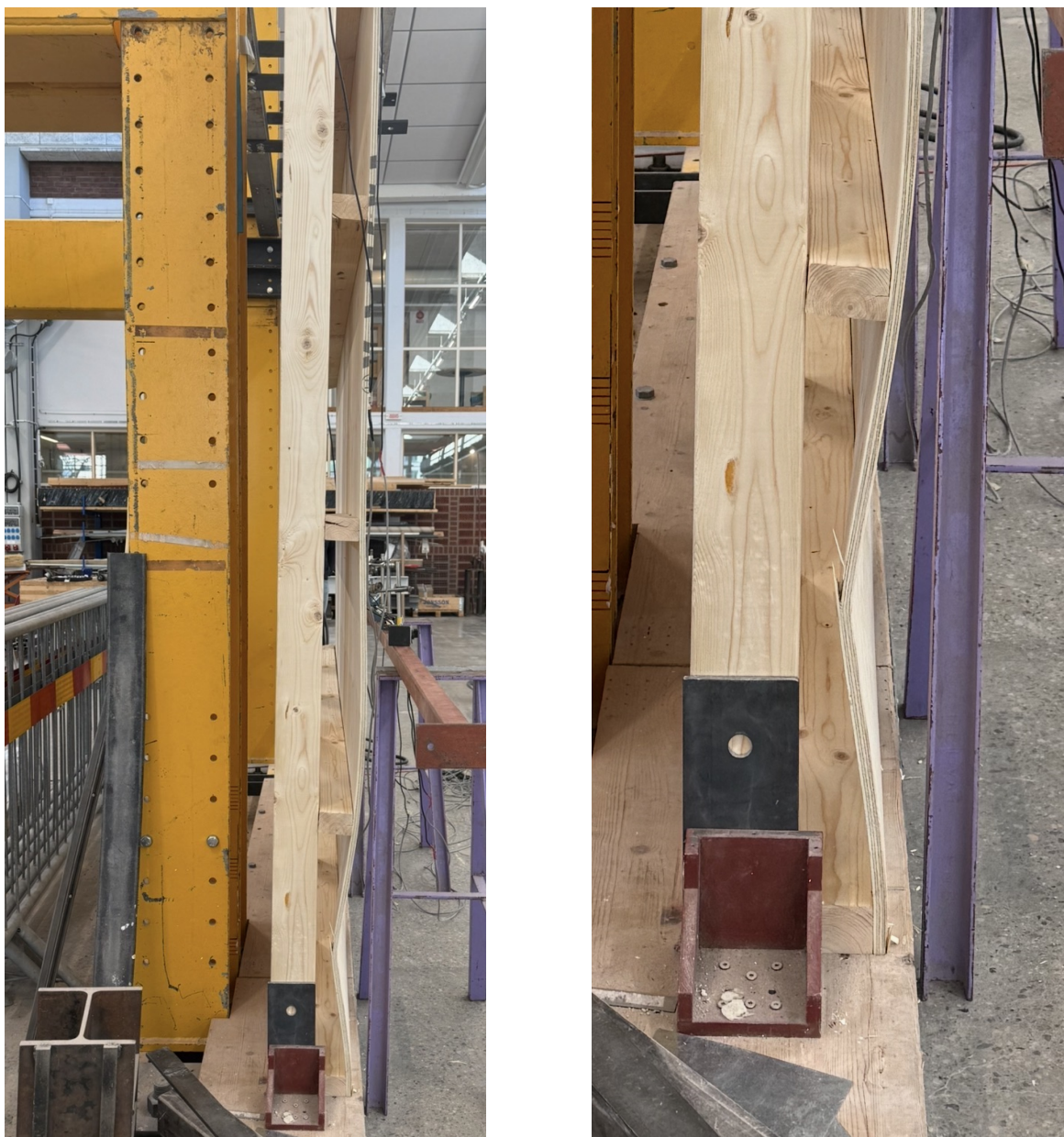
Figur 6.4: Deformation av plywoodskiva, Vagg 4.
