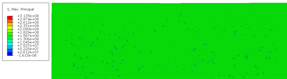
Figur 5.1: Dragspänningar i den höga vid initiering av böjsprickor.
