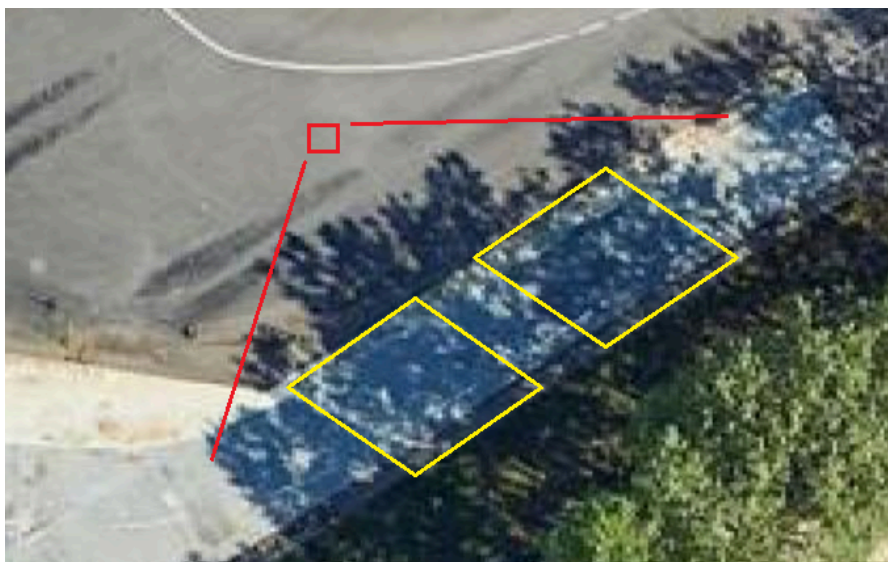
Figur 3.5.1: Illustration av placeringen av R2D110 (röd) med radarsensorns synfält och larmzoner (gul) på bulltoftabanen.
