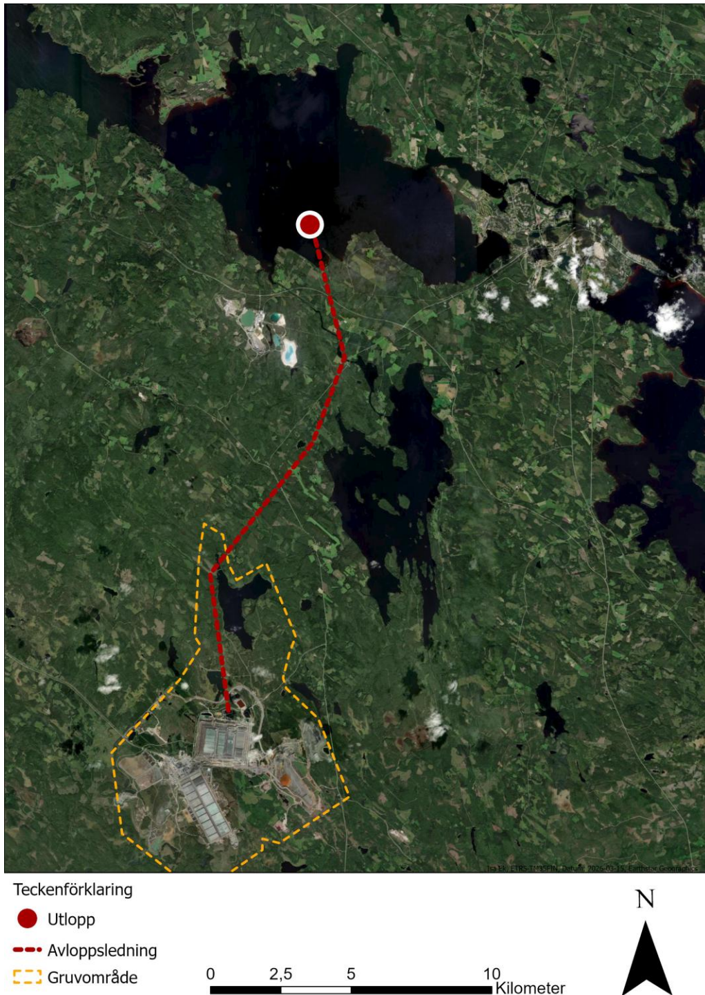
Figur 10 Avloppsledningens dragning från gruva till sjö (röd streckad linje) och avloppsrörets utlopp (röd punkt).
